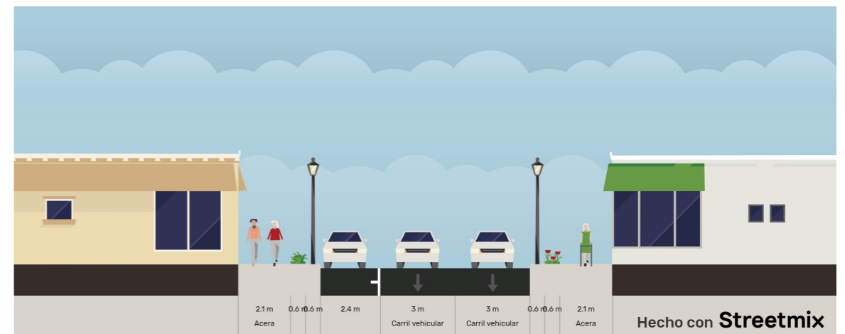
▲ Gráfico 20. Sección de vías de circulación internas en los barrios de la meseta. Fuente: ONU-Habitat 2023
