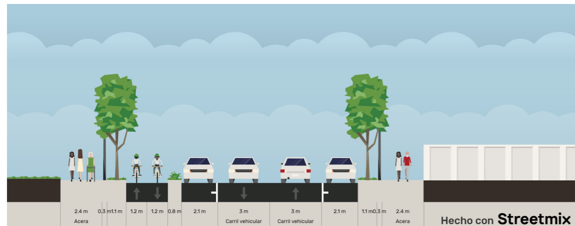
▲ Gráfico 21. Propuesta de diseño para la continuación de Avenida Martín Miguel de Güemes hasta Pasaje Trepo. Fuente: ONU-Habitat 2023
